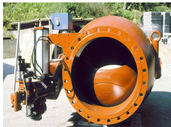
Kugelhahn der Biggetalsperre
